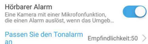
Um die Auslöseempfindlichkeit anzupassen betätigen Sie Sie Menü „Passen Sie den Ton...“ oder das Pfeilsymbol >. Der Standard voreingestellte Wert für die Auslöseschwelle ist 50.
