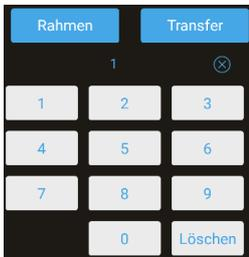
**Abspeichern:** Bewegen sie die Kamera durch Wischen auf dem Display des Mobilgerätes in die richtige mechanische Position. Bedienen Sie die Zoomfunktion bis der gewünschte Bildausschnitt dargestellt wird. Geben Sie mittels eingeblandeter Tastatur die Nummer ein unter der die Position gespeichert werden soll. Betätigen Sie die Taste „Rahmen“ um die Speicherung abzuschließen.
